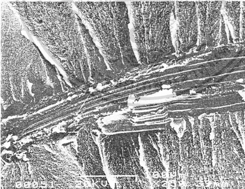
รูปที่ 4.31 แสดงพื้นผิวของคอมพอสิตจากเส้นใยที่ได้รับการปรับปรุง
