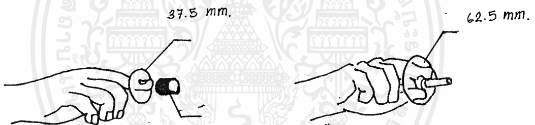
ภาพที่ 2.2.1.24 ขนาดของช่องที่สัมพันธ์กับนิ้วในการเข้าไปกด หรือบิดปุ่ม
