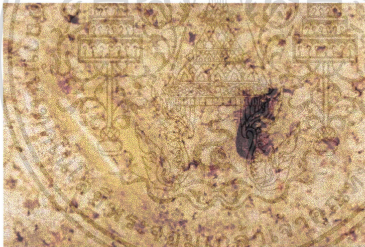
ภาพที่ 5 การปลอมปนของแกลบในรำข้าว กำลังขยายกล้องจุลทรรศน์ 20 เท่า
