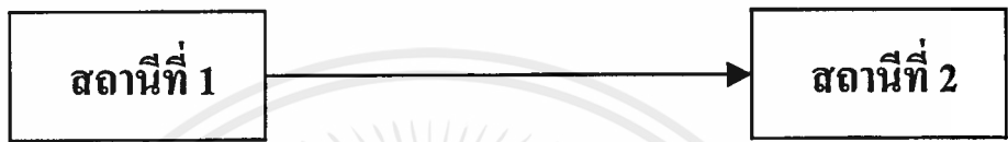
รูปที่ 2.19 การส่งสัญญาณแบบทิศทางเดียว (Simplex)
