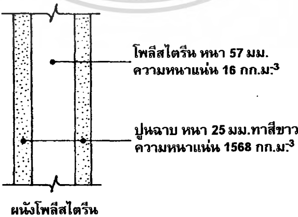
รูปที่ 5.6 แสดงลักษณะโครงสร้างของผนังโพลีสไตรีน
