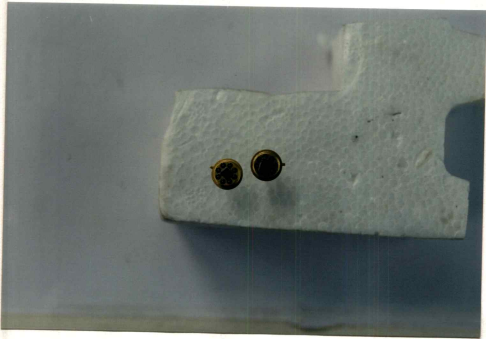
ภาพที่ 5.14 แสดงวงจรถ่ายก๊าซเซนเซอร์ที่สร้างเสร็จแล้ว บนตัวถัง TG-8
