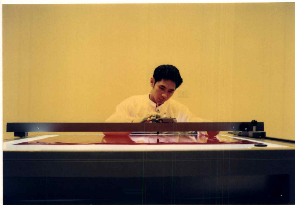
รูปที่ 5.4 แสดงการตัดลวดลายต้นแบบบนแผ่นพลาสติกกลามิเนตด้วยเครื่องไมโครคัตเตอร์
