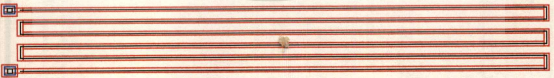
รูปที่ 4.15 แสดง Layout ของตัวต้านทาน 14.2 \text{ k}\Omega
