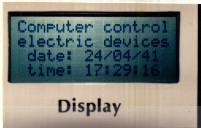
รูปที่ 4.5 การแสดงผลของจอแอลซีดี เมื่อทำการตั้งเวลา
