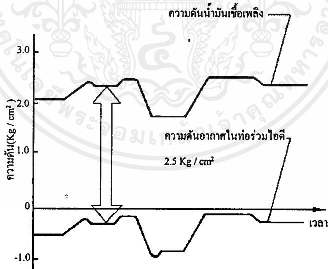
รูปที่ 2.33 กราฟการควบคุมความดันน้ำมันเชื้อเพลิง
