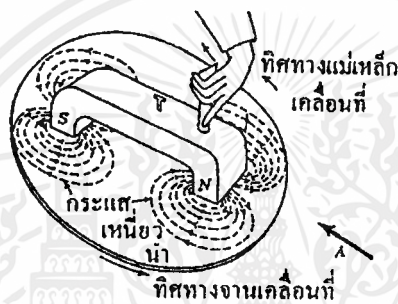
รูปที่ 2.2 แท่งแม่เหล็กรูปตัวยูวางคว่ำเข้าหาจานตัวนำ
