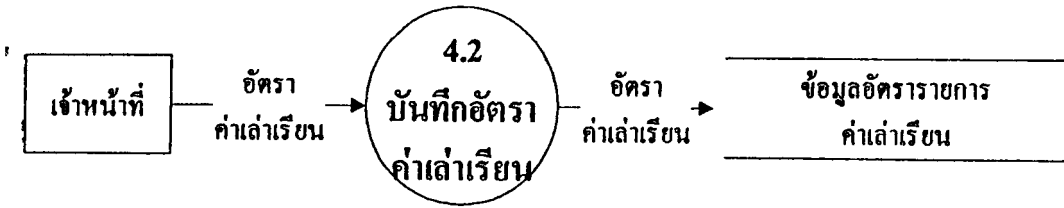
รูปที่ 4-21 ดาต้าโฟลว์ไดอะแกรม สำหรับการบันทึกข้อมูลอัตราค่าเล่าเรียน
