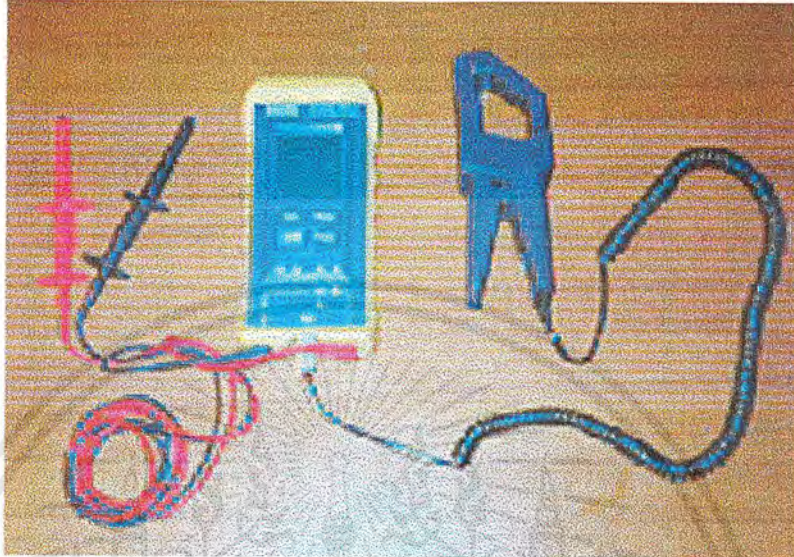
รูป 3.6 Power Meter
