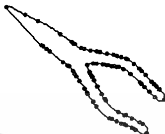
รูปที่ 7 แสดงถึงจุดเด่นของขอบภาพที่ \sigma = 3
