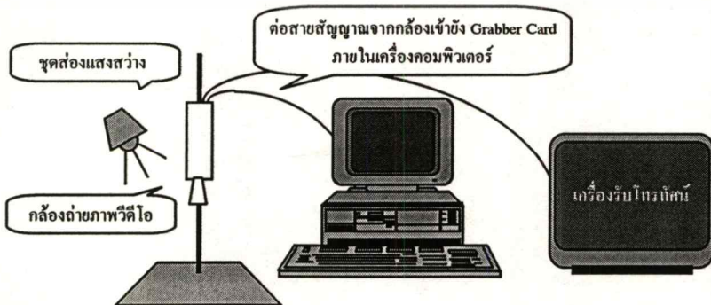
ภาพแสดงการติดตั้งอุปกรณ์ในระบบการจดจำภาพวัตถุ
