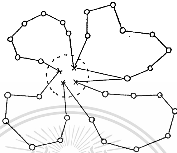
แผนภาพที่ 20 แสดงผลลัพธ์ของปัญหาการเดินทางของพนักงานขาย M คน
