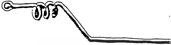
สปริงประเภทนี้ใช้ต่อเข้ากับโครงสร้างเฟรมของ เบาะที่นั่งและเบาะพนักพิง
