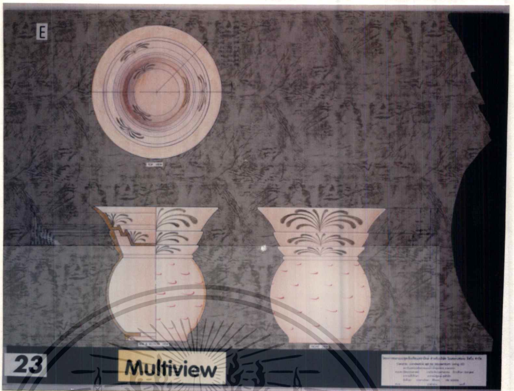
4.23 รูปด้านของเชิงเทียนที่ใช้กับเทียน Column เส้นผ่านศูนย์กลาง 7.5-15 cm.
