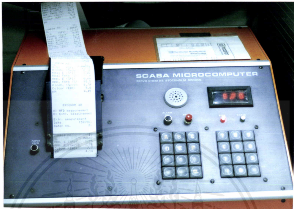
รูปที่ 33 เครื่อง Beer Detector ส่วน output
