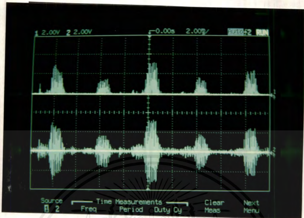
รูปที่ 4.6 แสดงสัญญาณเปรียบเทียบก่อนผ่านไดโอดและหลังผ่านไดโอด สัญญาณช่อง 1 แสดงข้อมูลหลังผ่านไดโอด สัญญาณช่อง 2 แสดงข้อมูลก่อนผ่านไดโอด
