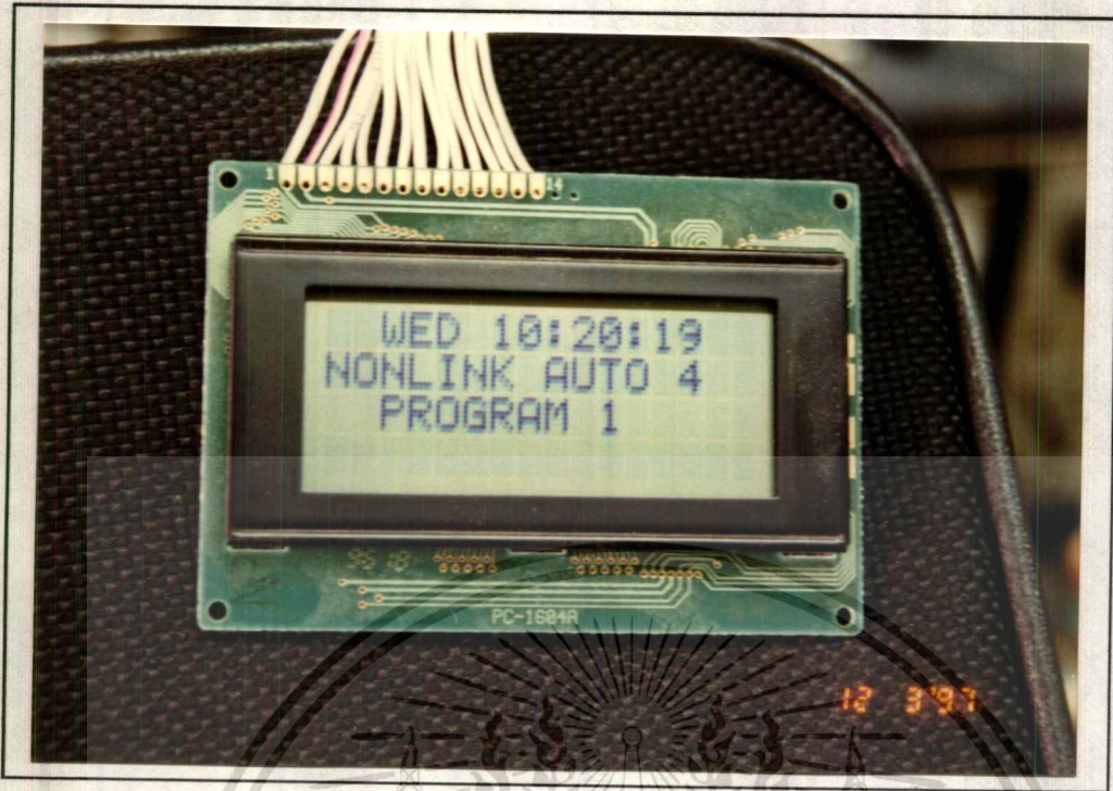
รูปที่ 2.5 แสดงจอภาพแสดงข้อมูลการทำงานของอุปกรณ์ควบคุมสัญญาณไฟจราจร
