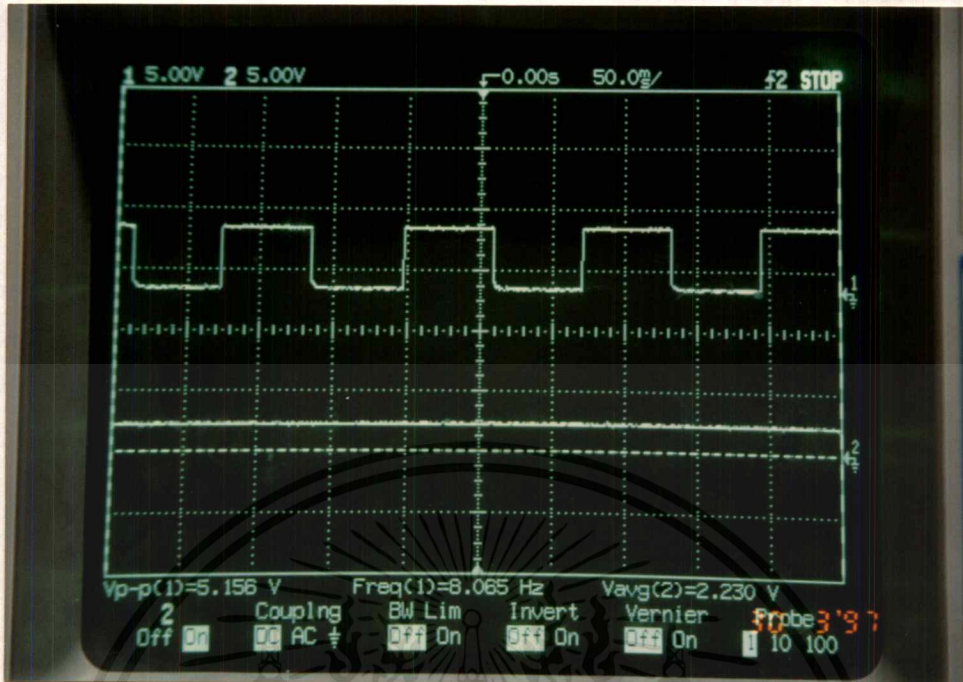
รูปที่ 4.13 แสดงค่าแรงดันที่ถูกขยาย (CH2) และค่าความถี่ที่ได้จาก VCO (CH1) ของเซนเซอร์ตัวที่ 1 ที่มุม 180 องศา
