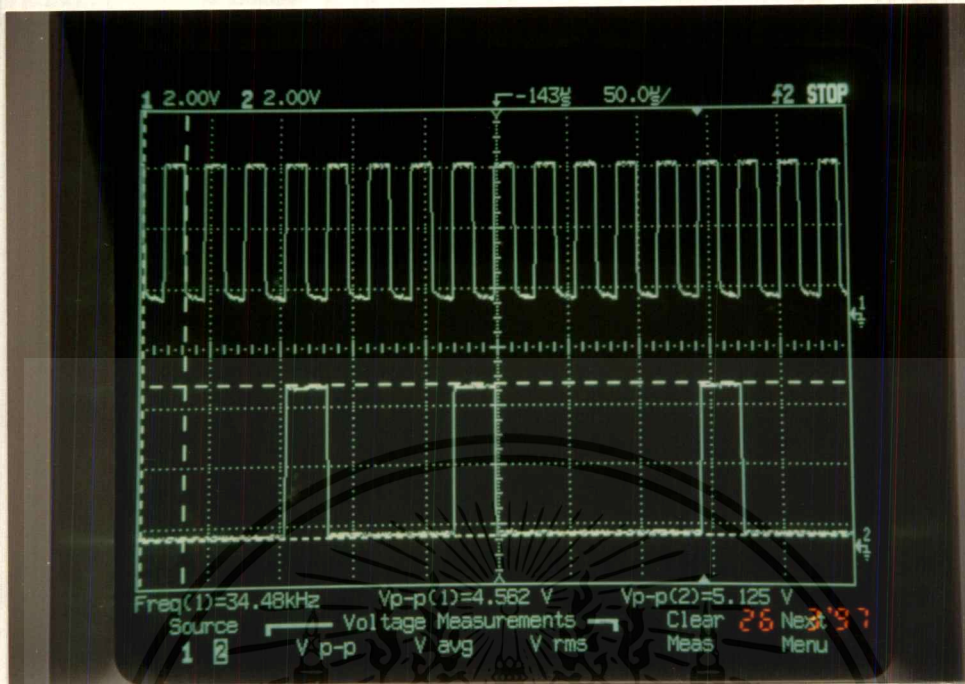
รูปที่ 4.11 สัญญาณอินพุตที่เข้าที่ขา 14 IC 4017 กับสัญญาณ RAS
