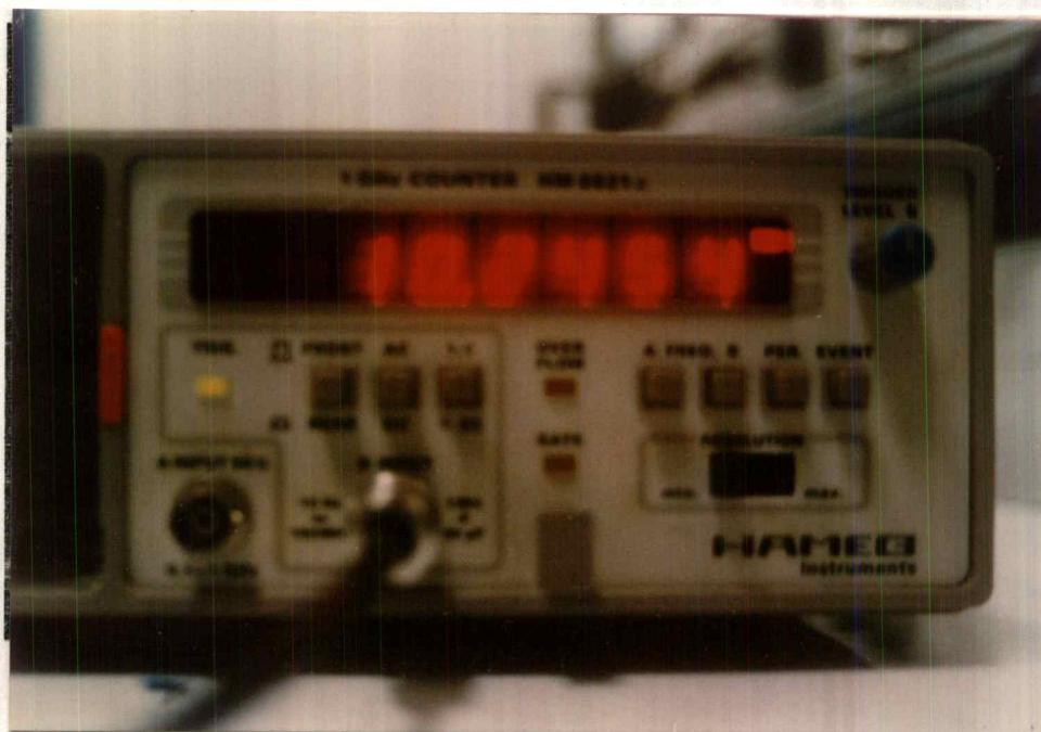
รูปที่ 4.3.3 ความถี่ของวงจรโดยวัดจากเครื่องนับความถี่ ( Frequency Counter ) จากรูปที่ 4.3.2 แสดงการออกสวิตช์เลขของวงจรโดยมีระดับสัญญาณ 2.594 V และในรูปที่ 4.3.3 เมื่อวัดความถี่โดยใช้เครื่องนับความถี่จะได้ค่าความถี่เท่ากับ 10.245 เมกะเฮิรตซ์
