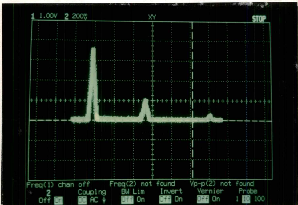
รูปที่ 4.8.4 แสดงการวัดสัญญาณสี่เหลี่ยม(square wave) 200 KHz ขนาด 700 mV จะเกิดสัญญาณฮาร์โมนิกที่(3) 600 KHz, ฮาร์โมนิกที่(5) 1MHz
