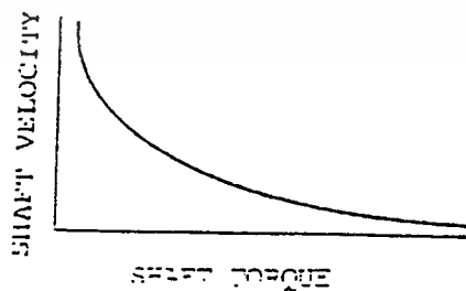
รูปที่ 2.20 แสดงคุณสมบัติระหว่างความเร็วและแรงบิดของดีซีมอเตอร์อนุกรมภายใต้ภาวะโวลต์เตตคงที่
