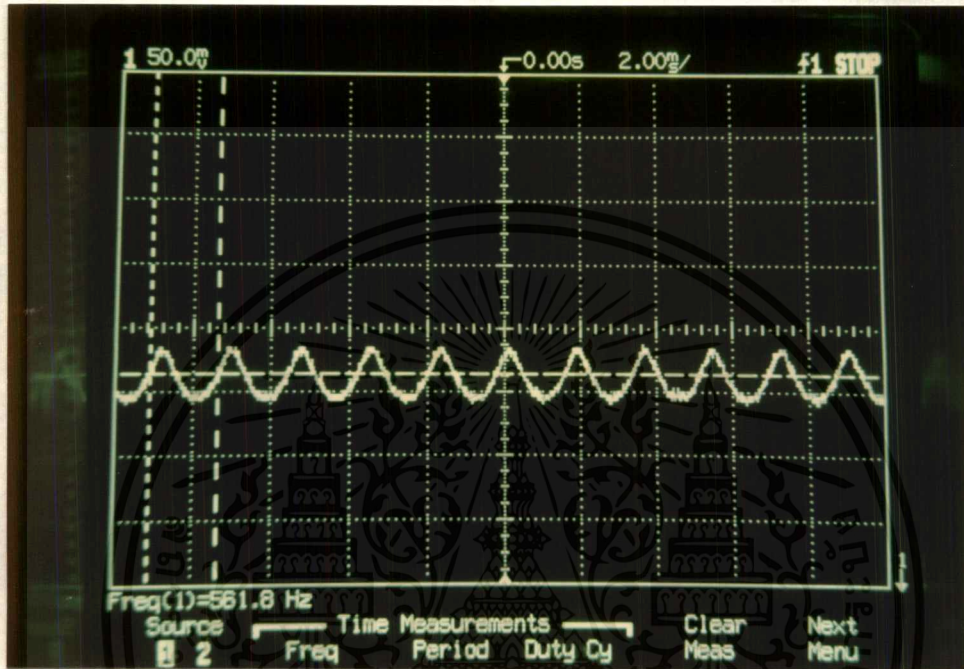
รูปที่ 4.14 สัญญาณที่ตีเทคได้ที่ขา 13 ของ 3362 เมื่อมอดูเลตด้วยฟังก์ชันเจเนอเรเตอร์ที่มีความถี่ 560 เฮิร์ตซ์ ทางด้านส่ง
