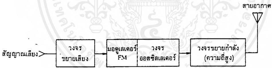
รูปที่ 2.5 แผนผังเครื่องส่ง FM อย่างง่าย
