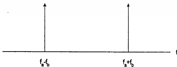
รูปที่ 2.22 เอาต์พุตของวงจรบาลานซ์มิกเซอร์ในโดเมนความถี่
