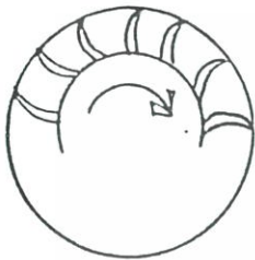
ใบพัดแบบโค้งหลังที่วัดโรตารีไฟล์อีกแบบหนึ่ง (แอร์ฟอยล์)
