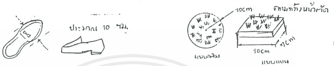
รูปที่ 2.63 ขนาดความกว้างของแปรจกับความกว้างส่วนหัวรองเท้า
