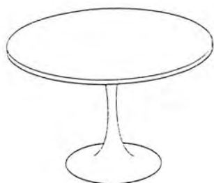
โต๊ะของซาลิเนน (ค.ศ. 1950) โต๊ะแท่นขาเดียว พื้นโต๊ะใช้พลาสติกขาว ฐานเป็นอะลูมิเนียมหล่อ เป็นยุคแรกของระบบการผลิตที่ใช้สารสังเคราะห์
