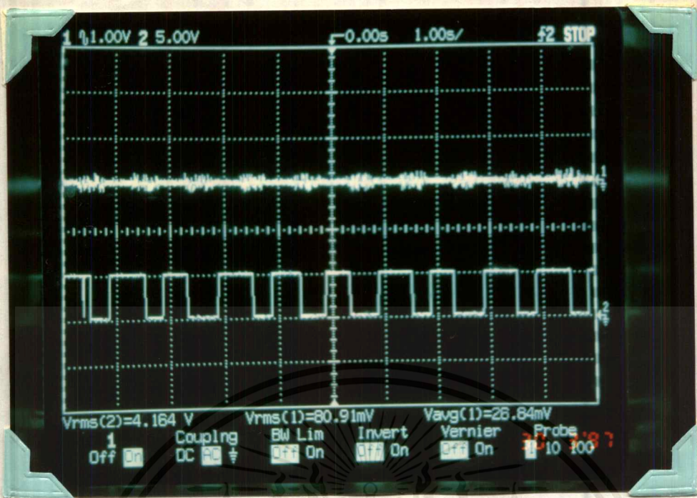
รูปที่ 4.3 แสดงการเปรียบเทียบสัญญาณสายไม่ว่างกับสัญญาณที่ขา 8 ของ IC LM567
