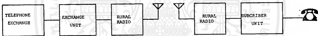
รูปที่ 2.6 แสดงการเชื่อมต่อระบบโทรศัพท์ กับ เครื่องวิทยุ
