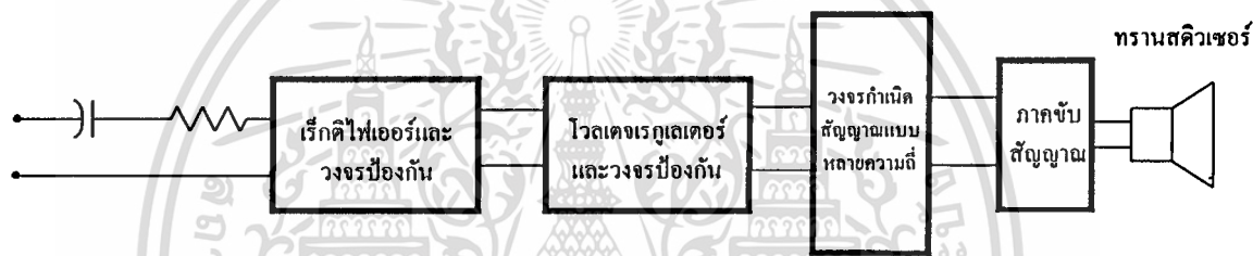
แสดงบล็อกไดอะแกรมของวงจรสร้างสัญญาณเรียกแบบหลายความถี่
