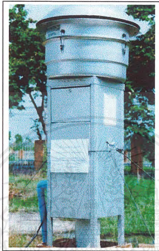
รูปที่ 2-5 เครื่องเก็บตัวอย่างอากาศแบบปริมาตรมาก ชนิดตัดแยกขนาดน้อยกว่า 10 ไมครอน
