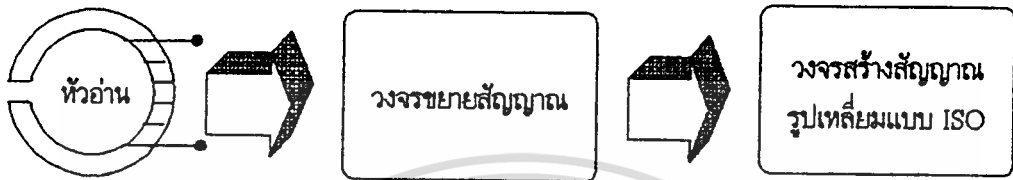
รูปที่ 2.10 แสดงส่วนประกอบของวงจรพื้นฐานสร้างสัญญาณรูปแบบ ISO จากบัตรแม่เหล็ก
