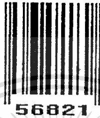
รูปที่ 2.3 แสดงตัวอย่างรหัสยูพีซี-อี (56821)
