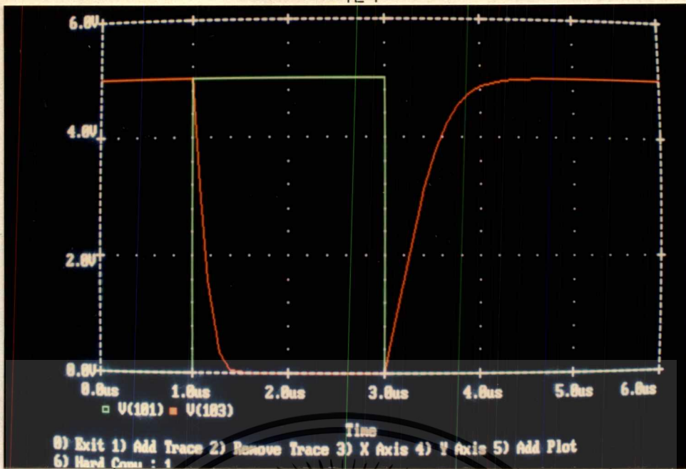
รูปที่ 5.11-3 แสดงผลการจำลองแบบคุณสมบัติสวิชชิงวงจรถนอร์เกต
