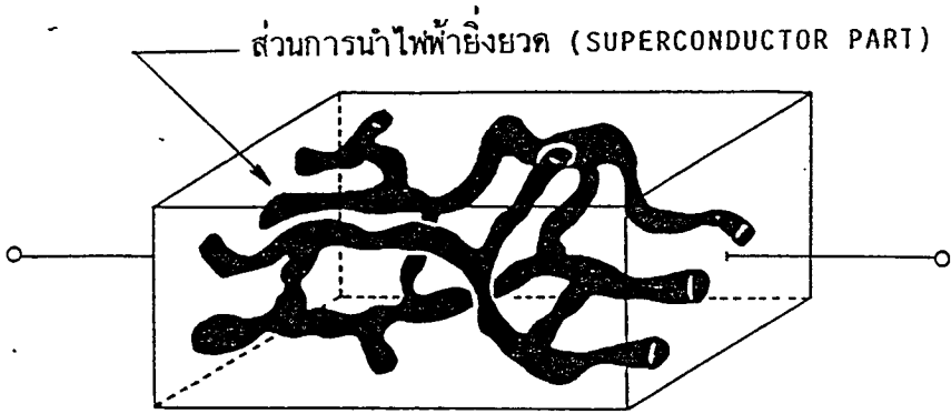
รูปที่ 5.1 สมมติฐานแบบจำลอง โครงสร้างภายในของสารตัวนำไฟฟ้ายิ่งยวดอุณหภูมิสูงชนิดเซรามิก ส่วนที่เกิดสภาพการนำไฟฟ้ายิ่งยวดเรียกว่า ส่วนการนำไฟฟ้ายิ่งยวด (Superconductor part)
