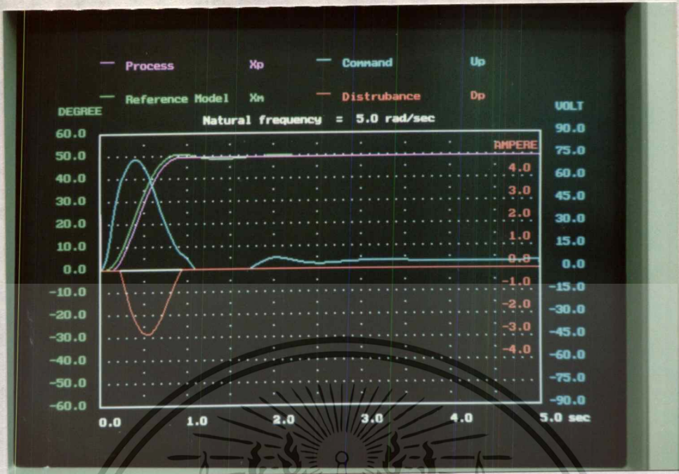
รูปที่ 4.23 แสดงผลตอบสนองเมื่อเปิดชั่วจ่ายไฟของเครื่องกำเนิดไฟฟ้า โมเดลอ้างอิงมีความถี่ธรรมชาติ 5 เรเดียน/วินาที มอเตอร์หมุนเป็นมุม 50 องศา ไรส์ไทม์ 0.9 วินาที เซ็ตดลิ่งไทม์ 0.9 วินาที ไม่มีโอเวอร์ชูท
