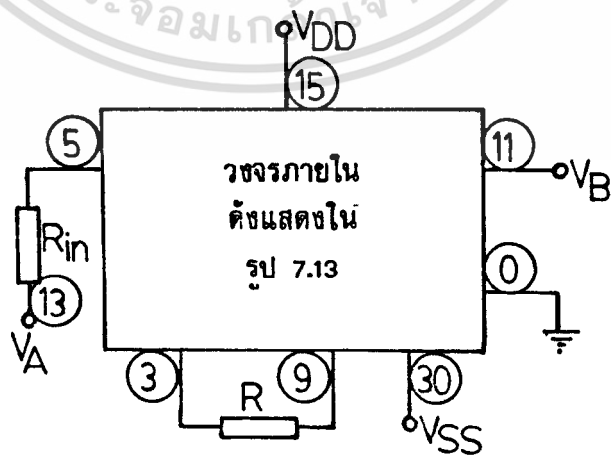
รูปที่ 7.13 แสดงวงจรแปลงความต้านทานค่าลบชนิดลอยตัวแบบคัทคาควบคุม โดยอาศัยหลักการของวงจรสะท้อนกระแส
