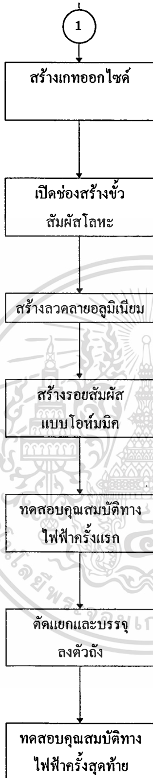
รูปที่ 4.1 กระบวนการสร้างทั้งหมดของอุปกรณ์ IGBT
