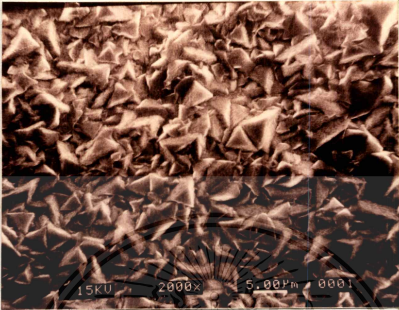
รูปที่ 5-1 แสดงลักษณะพื้นผิวของฟิล์มจากภาพถ่าย SEM ของระนาบ(111) ที่อุณหภูมิฐานรองมีค่า 950 องศาเซลเซียส
