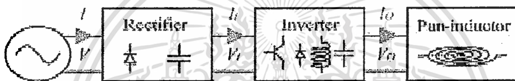
รูปที่ 3 โครงสร้างของเตาหุงต้มอาหารโดยการเหนี่ยวนำแบ่งออกเป็นบล็อกไดอะแกรม
