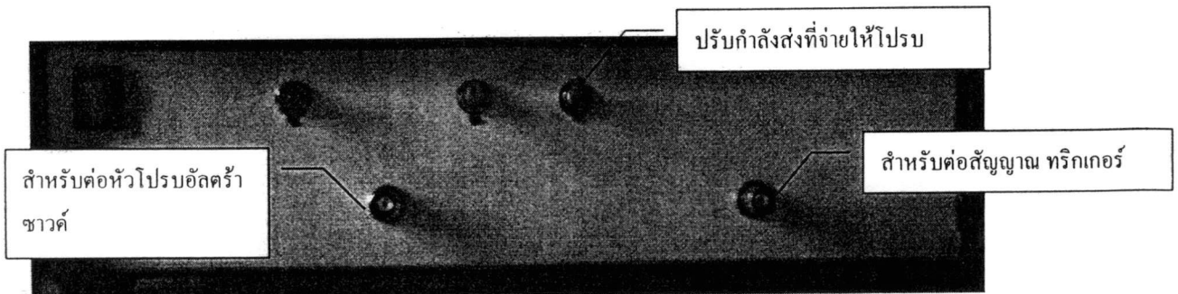
รูปที่ 1 แสดงด้านหน้าของ เครื่องกำเนิดสัญญาณพัลส์สำหรับหัว โพรบอัตร้าชาวด์
