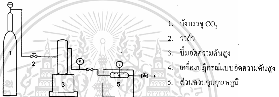
รูปที่ 3.2 แผนภาพกระบวนการย้อมสีเส้นใยไหมด้วยคาร์บอนไดออกไซด์เหนือวิกฤต
