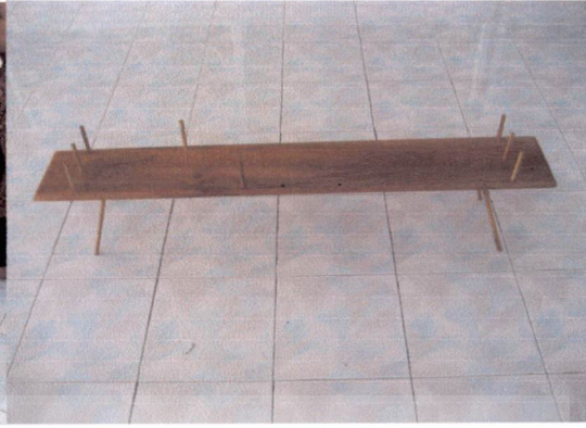
ภาพที่ 4.5 หลักฝื่อ ใช้สำหรับคั่นเครื่องทอ
