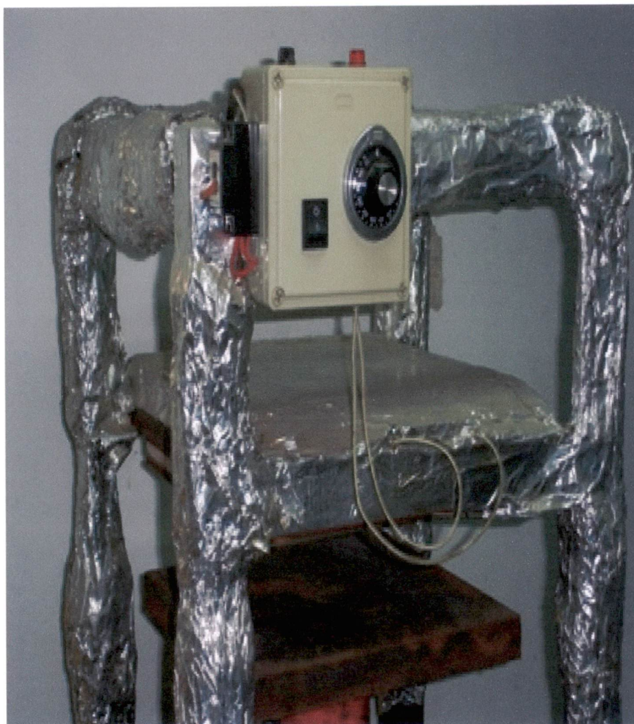
ภาพที่ 6 การเพิ่มฉนวนหุ้มกันความร้อนในโครงเหล็กที่ใช้ประกอบเครื่อง
