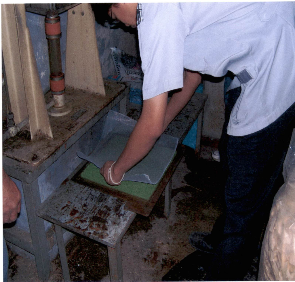
ภาพที่ 9 การนำเนื้อเยื่อพืชมาเข้าแบบที่มีความกว้าง 35x35 เซนติเมตร
