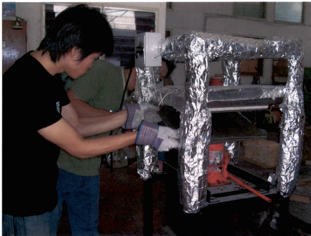
ภาพที่ 11 แสดงขั้นตอนการอัดร้อนกระดาษ
