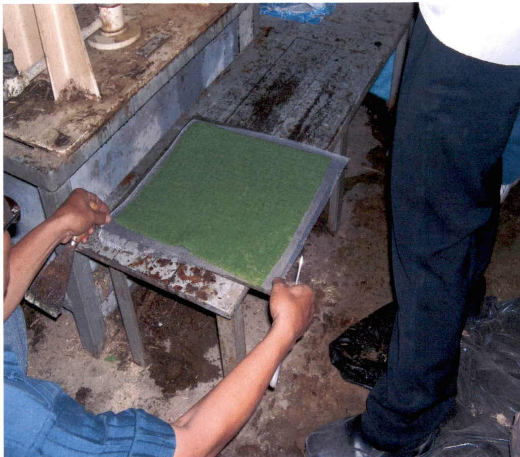
ภาพที่ 10 กระดาษหลังจากอัดเย็นเพื่อไล่น้ำออก
