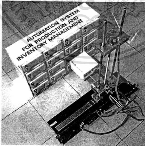
รูปที่ 8 ลักษณะการทำงานร่วมกันของระบบอัตโนมัติที่ช่วยในการจัดเก็บวัสดุคงคลังและลิ้นชัก
