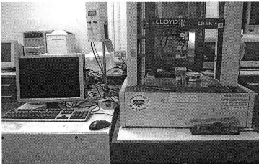
ภาพที่ 3.10 เครื่องทดสอบอเนกประสงค์ (Universal testing machine)
