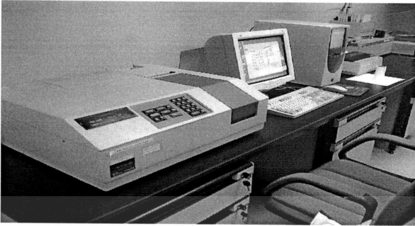
ภาพที่ 3.4 เครื่องวัดฟลูออริสเซนซ์ฟลูออริสเซนซ์สเปกโตรมิเตอร์
