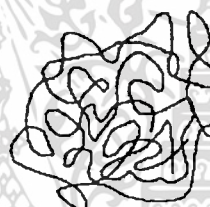
รูปที่ 3.7 โพลีเมอร์แบบ Amorphous thermoplastics
