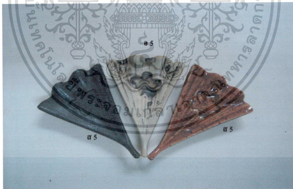
รูป 4-8 แสดงชิ้นงานผลิตภัณฑ์ด้วยบรรยากาศรีดักชัน (Reduction Firing RF.) อุณหภูมิการเผา 1250 °C
